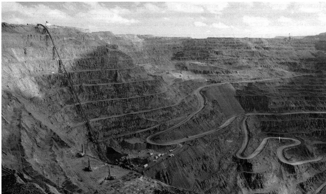
Рис. 1 – Крутонаклонный конвейер на карьере «Мурунтау»
